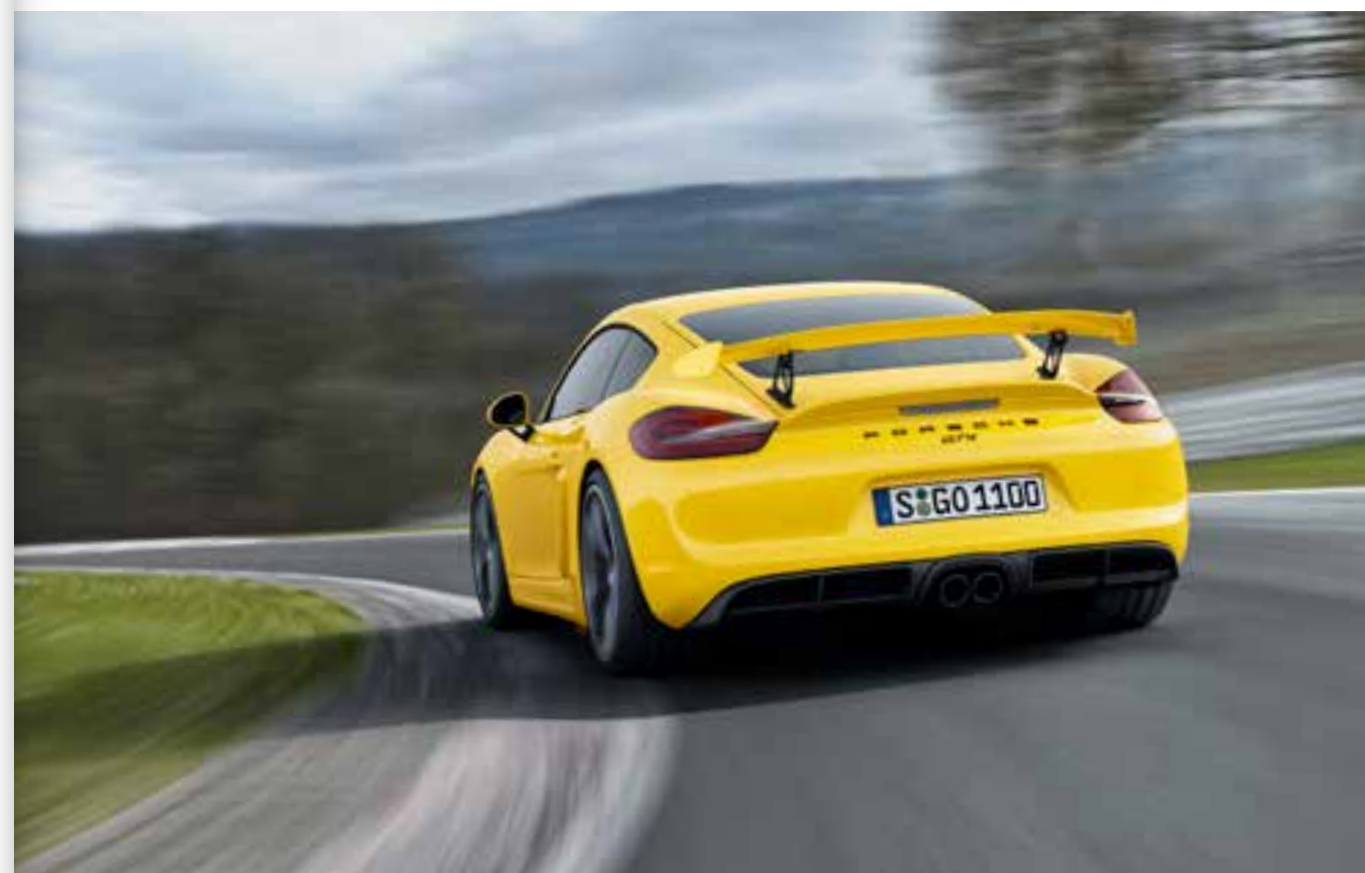
Rennstrecken-Gen: Der Heckflügel des Cayman GT4 ist je nach Einsatzzweck einstellbar.
