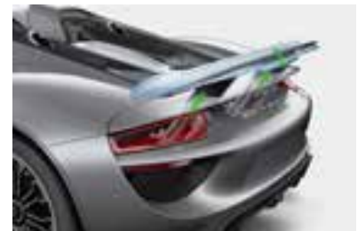
Porsche Active Aerodynamics (PAA) beim 918 Spyder: Kühlluftklappen, Frontdiffusor und Heckflügel stellen sich auf Fahrsituation und Fahrmodus ein.
