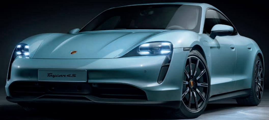
Der Taycan 4S unterscheidet sich auch im Exterieur in einigen Details von seinen Modellbrüdern. So sind Bugunterteil, Seitenschweller und Heckdiffusor in Schwarz gehalten. Auch die Unterschalen und Füße der Außenspiegel sind schwarz. Die Leisten der Seitenscheiben sind in Silber (Hochglanz) ausgeführt, die Bremssättel in Rot lackiert.
